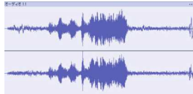
図4 不快音の逆位相の波形 (縦軸:振幅 横軸:時間)
