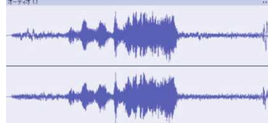
図3 不快音の波形 (縦軸:振幅 横軸:時間)
